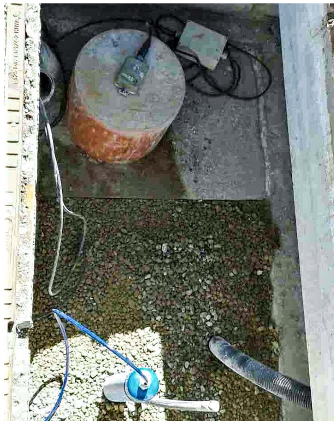
Abb. 4: Das Kabel des Bohrlochseismometers wird durch die blaue Verschlusskappe herausgeführt. Auf dem rötlichen Sockel links oben steht ein weiteres Seismometer zur Starkbebenmessung.
